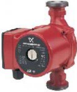
La función es hacer circular el agua del circuito a los radiadores o suelo radiante, la bomba se hace funcionar mediante un termostato de contacto y va conectada a la red eléctrica. La bomba se puede conectar a la ida y al retorno ya que funcionará en los dos sitios, pero es muy recomendable ponerla al retorno con el fin de no castigarla innecesariamente con temperaturas tan altas como en la ida, y con esto alargar la vida útil de la bomba.
